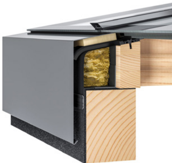
Fullt isolerad sarganslutning med tätskiktsmembran och runtomliggande takfotsplåt av 2 mm aluminium.
