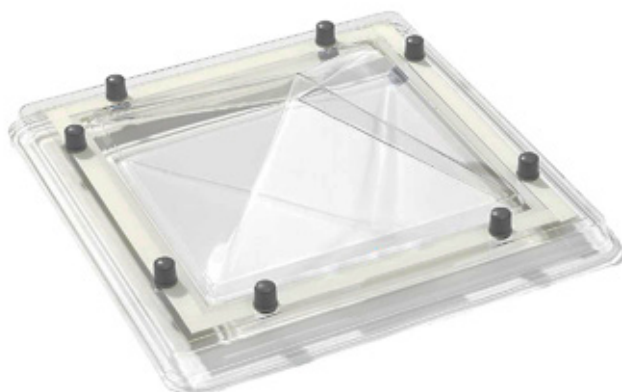
Pyramidformad kupa för kvadratisk eller rektangulär sarg. Pilhöjd kupa = 1/3 av ljusöppningsmättet.
