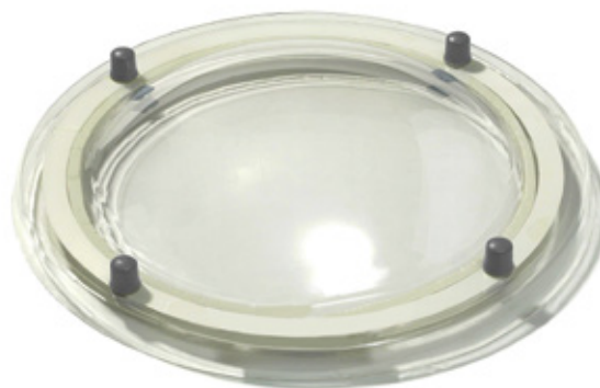
Välvd kupa för cirkulär sarg. Pilhöjd kupa = 1/5 av ljusöppningsmättet.
