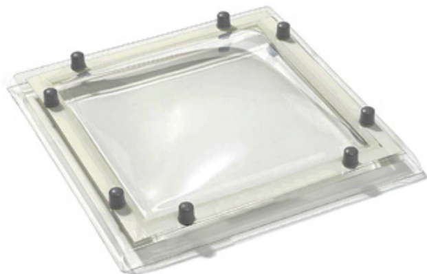
Välvd kupa för kvadratisk eller rektangulär sarg. Pilhöjd kupa = 1/5 av ljusöppningsmättet.
