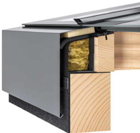
Fullt isolerad sarganslutning med tätskiktmembran och runtomliggande takfotsplåt av 2 mm aluminium.
