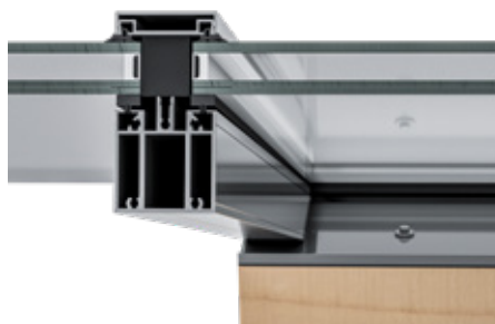
Sarganslutning med takfotsplåt av 2mm aluminium, utan eller med isolering.
